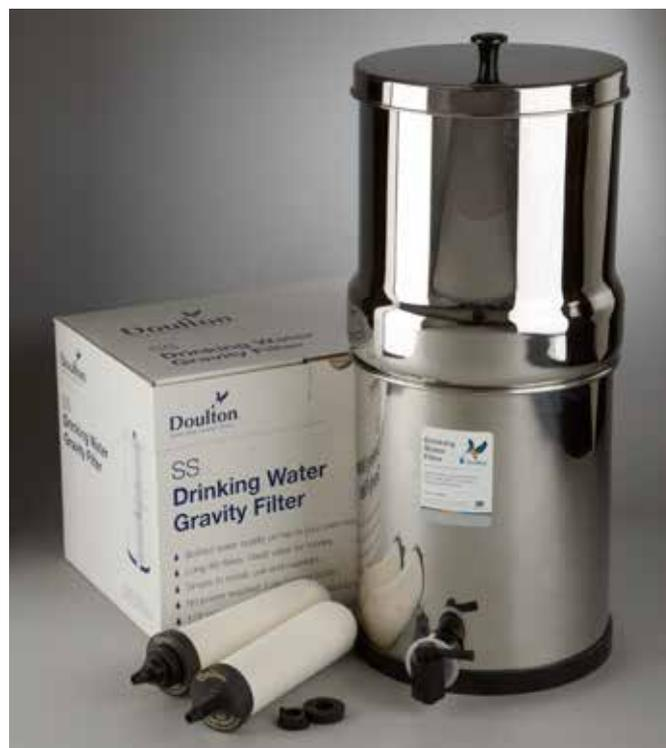
L'unità filtrante Decanter è composta da due contenitori, il contenitore superiore viene riempito con acqua non trattata che poi filtra nel contenitore inferiore attraverso un certo numero di candele filtro in ceramica. Il numero del filtro delle candele utilizzate dipende dalla portata richiesta:
